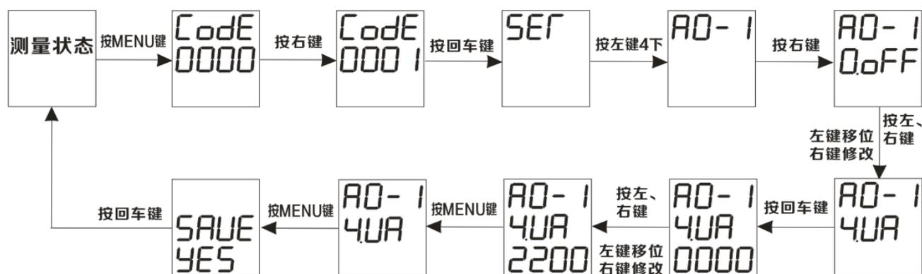
注意: 仪表在进入设置菜单后, 如果连续 1 分钟没有任何按键操作, 系统将自动退回到测量页面, 之前的设置无效。
