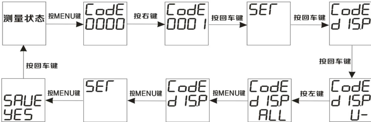
页面显示方式可设置为：相电压（U-）、线电压（UL-）、电流（I-）、总功率（PqS-）、分相有功（P-）、分相无功（q-）、分相视在功率（S-）、功率因数（P-）、频率（F-）、总有功电能（EPS-）、正向有功电能（EP-）、总无功电能（EqS-）、正向无功电能（Eq-）、开关量（dIO-），循环显示（ALL），也可通过左、右按键切换显示。
