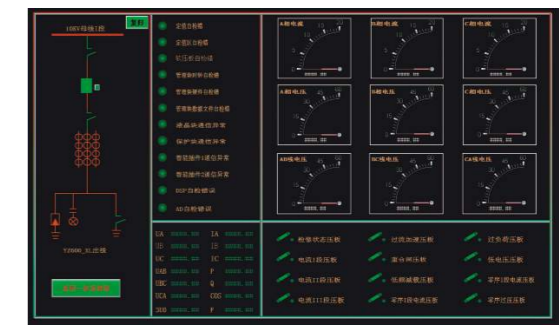
图1-6 变电站出线监控画面
